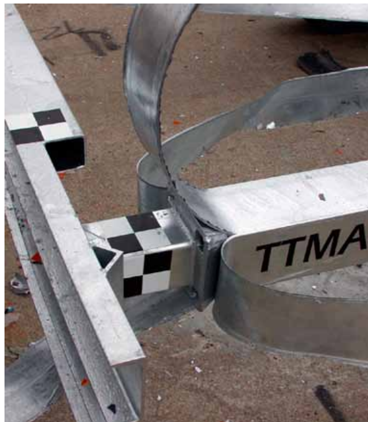
BILD 11: DE ENERGIABSORBERANDE RÖREN SPLITTRAS
